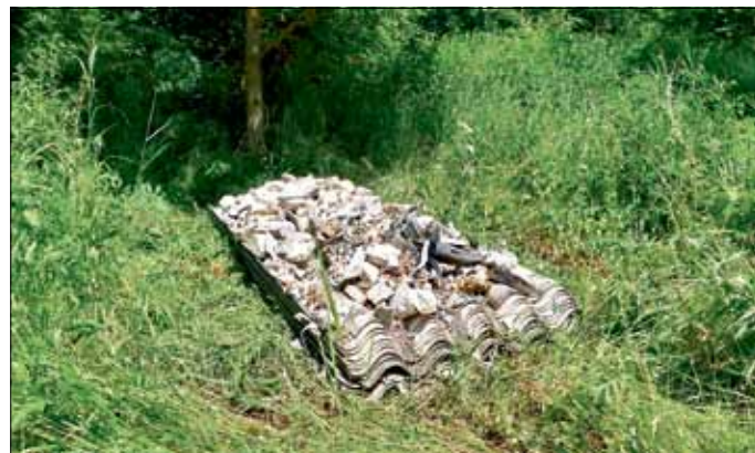
Fein säuberlich aufgeschichtete und mit Bauschutt bedeckte Wellasbestplatten am Zirkelschacht
