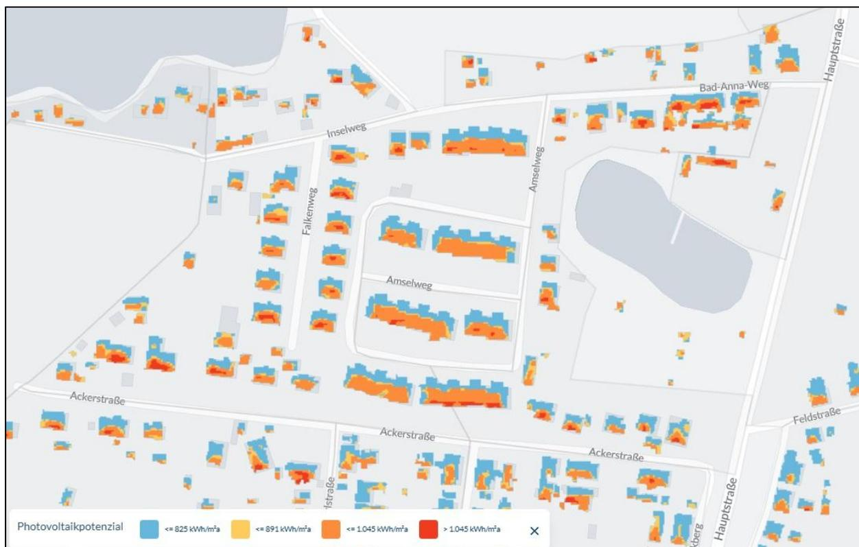
Abbildung 41: Photovoltaik-Potenzial auf Dachflächen in Helbra (beispielhafter Ausschnitt)
